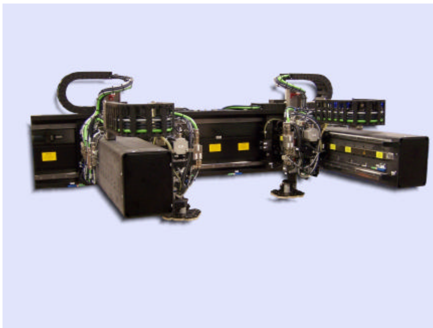
Bild 3: Doppel-XYZ-Positioniersystem mit CFK-Auslegern
